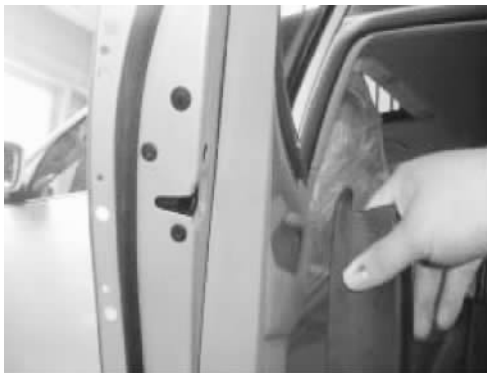
图 1-21 取下车门立边密封条
