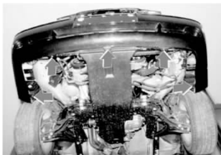
图 1-29 拆除前保险杠下方与车身相连接的螺钉
