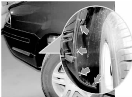
图 1-28 拆除前翼子板下方两侧与保险杠相连的螺钉
