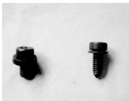
图 1-23 两种不同固定车门面板的固定螺丝
