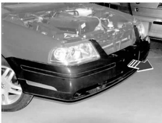
图 1-25 拆卸固定前车牌的四个铆钉
