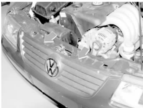
图 1-26 拆除进气格栅上的两个固定螺钉
