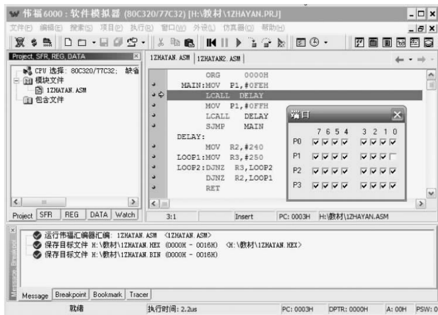
图 1-22 “眨眼”的 LED 灯程序仿真图(字节操作)
