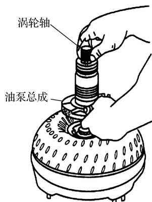
图 4-19 导轮和涡轮之间的干涉检查
