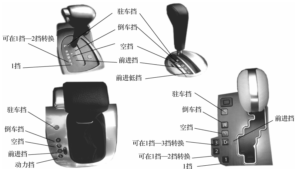
图 4-5 典型自动变速器的操纵手柄及挡位布置
