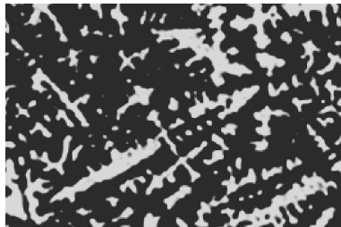
图 4-16 Cu-Ni 二元合金的枝晶偏析
