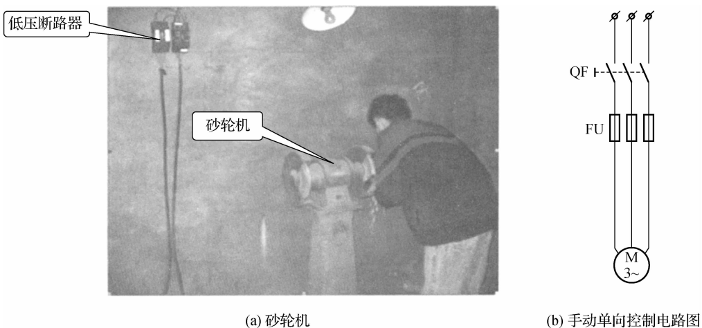
图 1-5 单向控制线路典型应用案例——砂轮机
