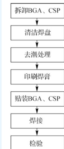
图 6-8 BGA、CSP 芯片的返修工艺流程
