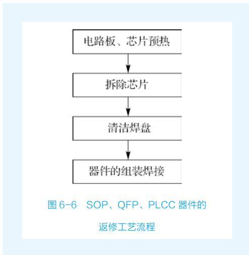
图 6-6 SOP、QFP、PLCC 器件的返修工艺流程
