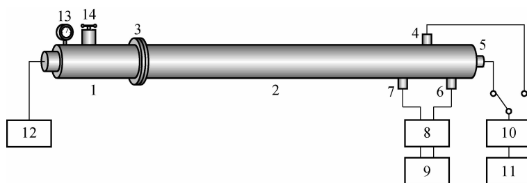
图 1.5.9 激波管标定装置系统原理框图
