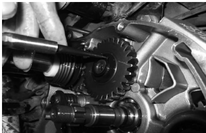
图 4-16 外卡簧钳的使用方法
