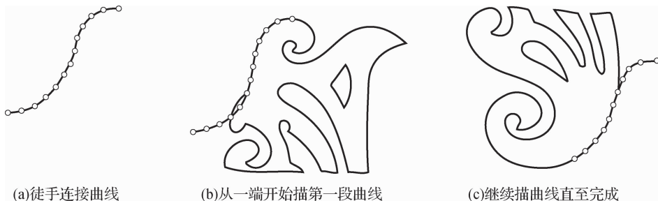
图 1-16 曲线板的用法
