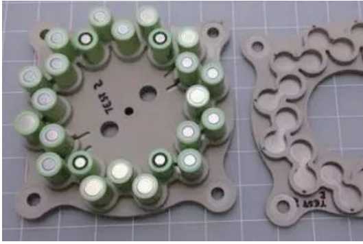
图 1-3 3D 打印技术制造的电池安装板
