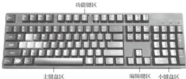
图 1-5-21 计算机标准键盘的结构
