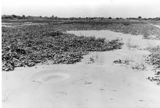
图 1-7 我国唐山地震时砂土液化地面出现的喷水冒砂现象
