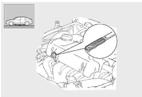
图 1-21 检查发动机机油
