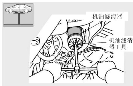
图 1-10 更换发动机机油滤清器
