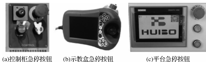
图 1-2 工业机器人应用编程实训平台急停按钮
