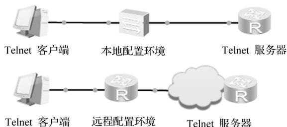
图 1-1-2 终端通过 Telnet 对本地和远程网络设备进行管理
