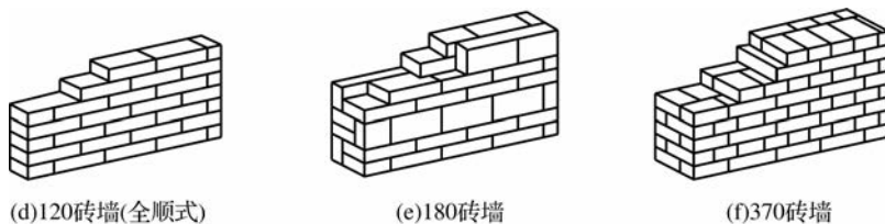
图 3-6 砖墙的组砌方式
